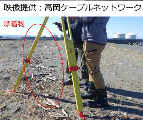
砂浜に残っている漂着物、証言情報、CCTV映像等によって津波痕跡を特定し、富山県沿岸部では1-2m、新潟県上越市では3-4mの津波遡上高を測定した。映像で地震発生直後に住民、観光客が早期に避難したことを確認できた。
