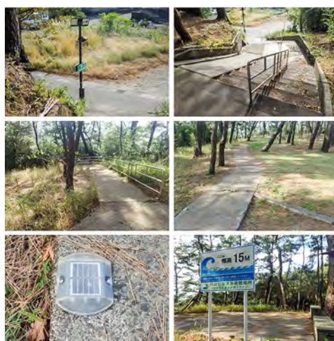
図 28 円山公園津波避難場所（上段左：避難場所入口のサイン，上段右：手すり付き階段・スロープ，中段左：手すり付きスロープ，中段右：公園内の道，下段左：これらの経路に数多く設置された太陽光発電の誘導灯，下段右：頂上のピクトグラム付きサインと救命胴衣を収納したベンチ格納箱）
