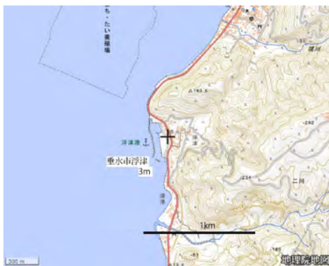
図 12 浮津（鹿児島県垂水市浮津）での推定津波浸水高
