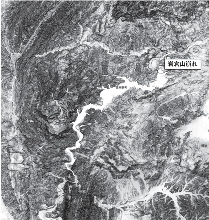
図13 犀川丘陵の傾斜量分布図と岩倉山地すべりの湛水範囲（（有）地球情報・技術研究所 井上誠作成）
