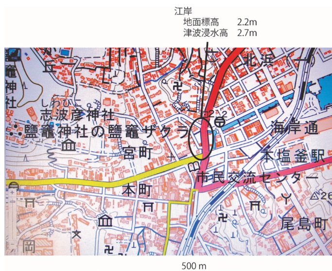
図3 塩釜の江岸地区（楕円で囲んだ部分）、ほぼ平坦市街地で地区内の水準点はTP2.2mである。ここでの津波浸水高は2.7mと推定される。
