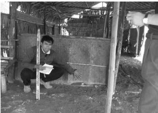
Photo. 24 Pandansari 浜 右写真, 竹編みフェンスの下方の白く変色している部分が海水浸水があったことを示している 右側写真に写っているのは Fachrizal 氏である
