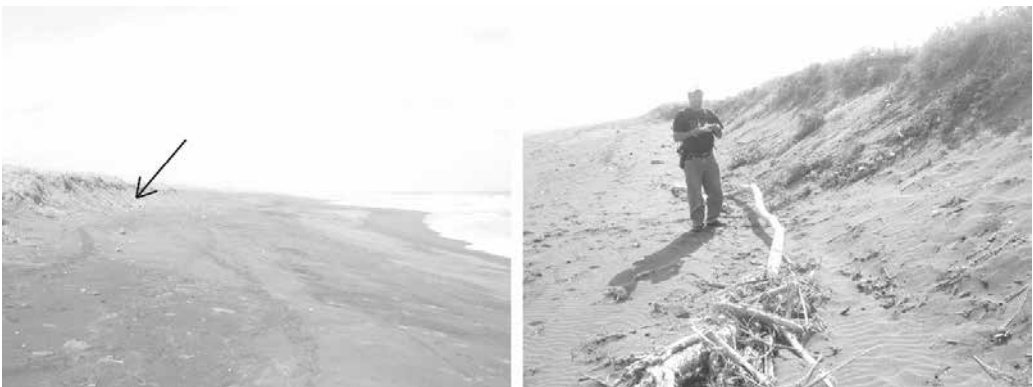
Photo. 14 Pantai Ambal 海岸の木材，ゴミの列（左写真矢印，および右写真）この列の標高を測定したが，津波は実際にはこの背後の段差の上端まで来た可能性がある
