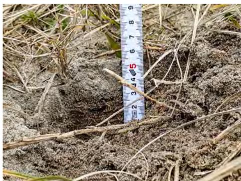
写真27 遡上限界付近から確認された津波堆積物
