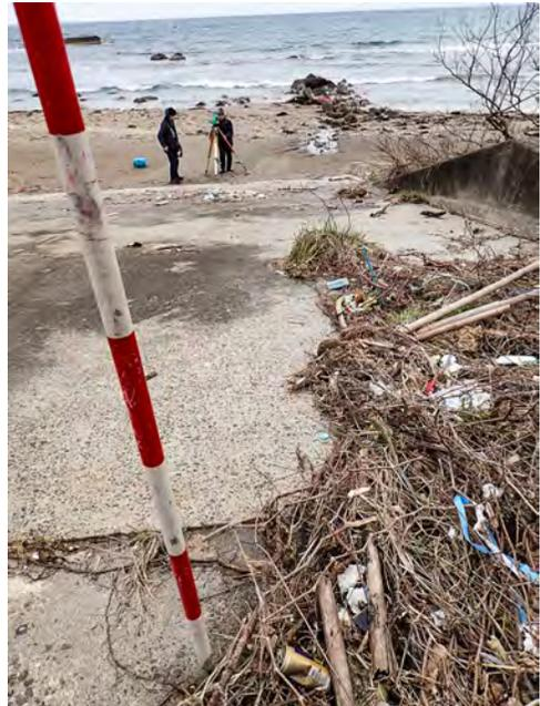
写真 44 海浜背後のコンクリートスロープ上端の遡上限界の漂流物帯
