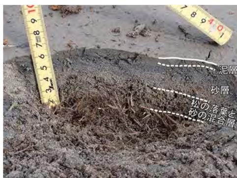
写真 40 運動公園内の敷地に分布する津波堆積物 有機質土壌の上位に松の落葉と砂の混合層、砂層、および泥層を認めた。境界面は不明瞭であった。
