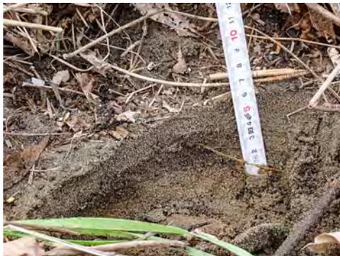
写真 12 遡上限界付近から確認された津波堆積物
