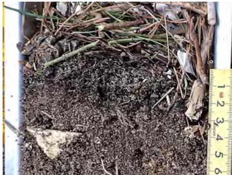
写真 47 ジオスライサーで採取した遡上限界付近の津波堆積物
