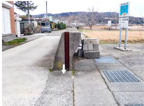
写真 55 住民の証言から推定した津波により浸水した最高高度地点（矢印）防潮堤背後（写真左）の住宅には津波による損傷は見られなかった。
