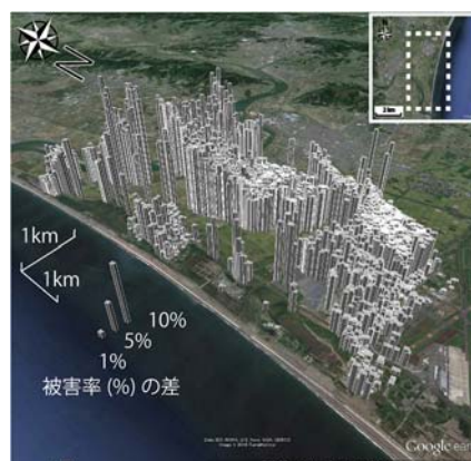
図-4 図-1 における海岸林の有無による岩沼市の建物被害率の差の算定値 (Image©TerraMetrics)
