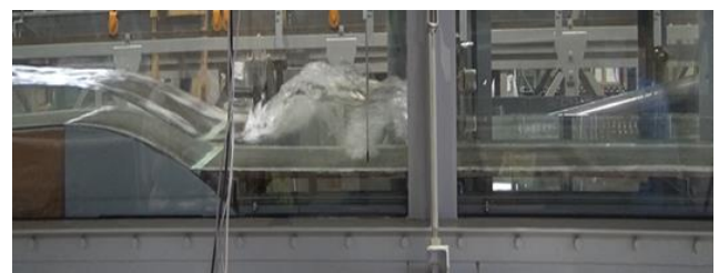
写真-1 湖沼突入直後の津波の様子
