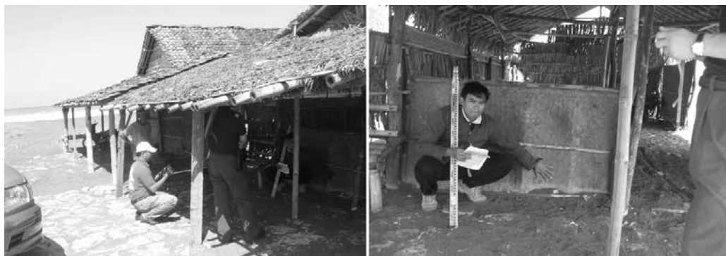
Photo. 24 Pandansari 浜 右写真、竹編みフェンスの下方の白く変色している部分が海水浸水があったことを示している 右側写真に写っているのは Fachrizal 氏である
