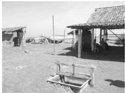
Photo. 16 Keburuhan の海岸のこの家屋の支柱の下端から 90cm のところまで浸水した (証言)
