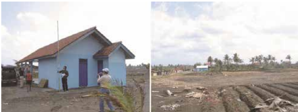
Photo. 5 Lengkong (Kota Cilacap)での浸水痕跡測定(左)と、津波で運ばれてきた畑地の漂流物(右)
