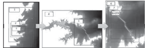
図 9 計算領域図 (8+STR とある領域に CADMAS-SURF と STR の連成領域が設定されている)
