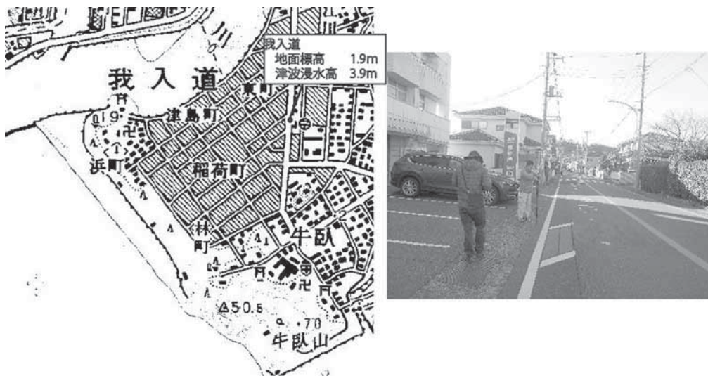
図 33 沼津市我入道での安政津波の浸水高測定
