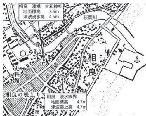
図 40 牧之原市相良の大和神社での津波標高測定
