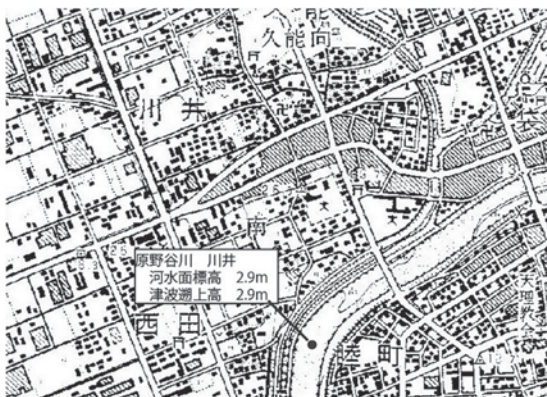
図42 太田川支流の原野谷川の袋井市川井点での河岸面の標高測量
