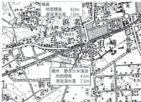
図 8 湖西市新居町浜名橋本での慶長 9 年地震 (1605) による津波高測定 下左図は国道橋本交差点, 下右図は浜名棒鼻で, こちらのほうが古い街道筋である。
