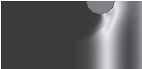
図 10 浅瀬が主として後方にある島嶼周辺の水位分布 ( t = 46.0 s)
