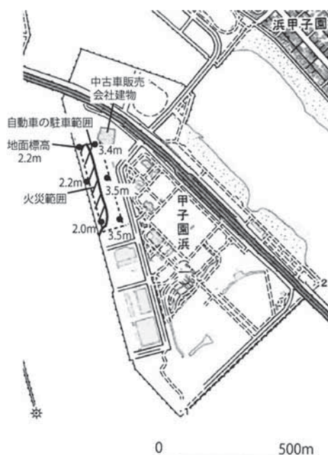
図8 西宮市甲子園浜一丁目人工島の中古車展示場での自動車火災 破線長方形部分に自動車駐車してあった。海側の標高は2.0~2.2m。山側の標高は3.5mほどである。海水はこの展示場駐車場の海側から2/3あたりの範囲まで浸水し、一番海側の車両は0.8m~1.0mの高さまで浸水したようである。
