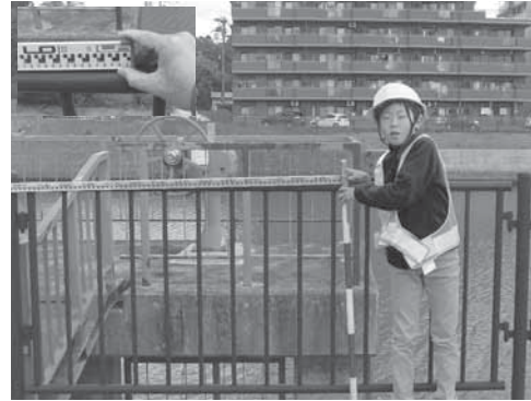
図9 笠神新橋下流右岸 樋門操作台の寸法計測(5m)
