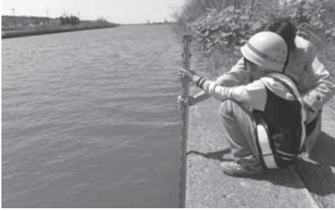
写真 2.4 鋼矢板護岸笠コンクリート高さ及び貯木場水深(図 3③)
