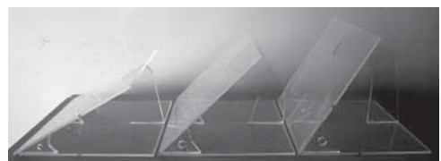
図2 崩落体モデル（それぞれ、左から順に、斜面勾配が \beta = 60^\circ 、 45^\circ 及び 30^\circ の場合の実験で用いる。）
