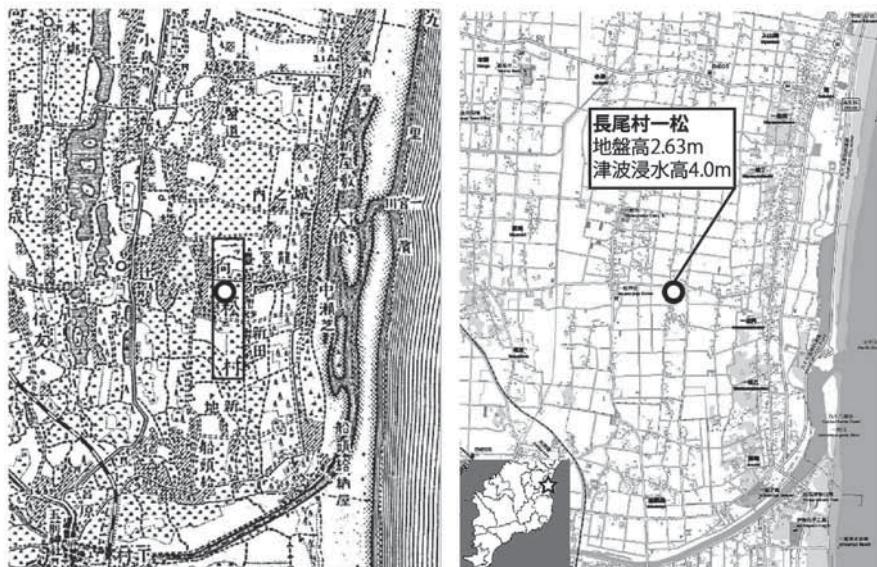
図 17 長生村一松での測定位置と津波浸水高
