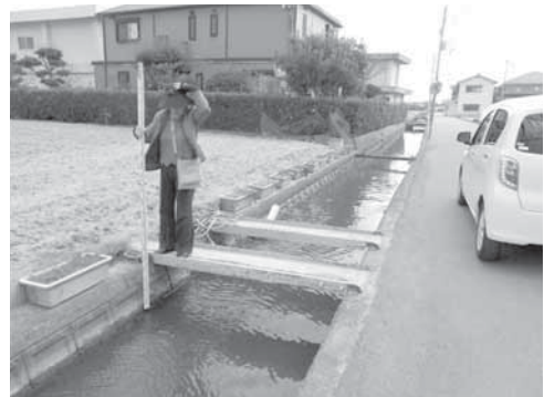
写真4 中江での水面測定 田畑の標高は水面上0.5m前後しかない
