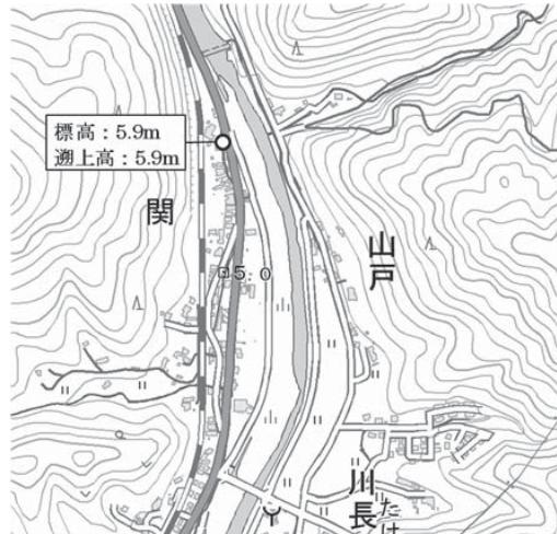
図 16 牟岐町川長・関地区の測定点 関で最高所の家と2番目の高所の家の敷地の中間の高さを測定した。
