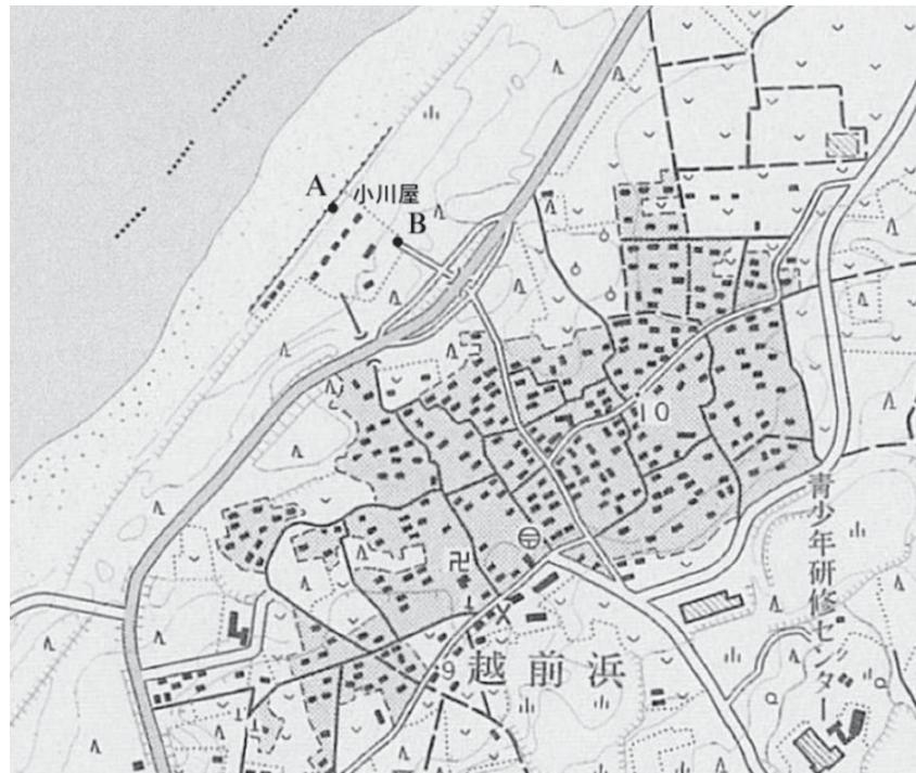
図18 現在の越前浜 越前浜集落は砂丘の背後にあるが、砂丘の前面に小川屋をはじめとする釣宿が並んでいる。砂浜の限界点Aと越前浜集落への入り口の点Bで標高を測定した
