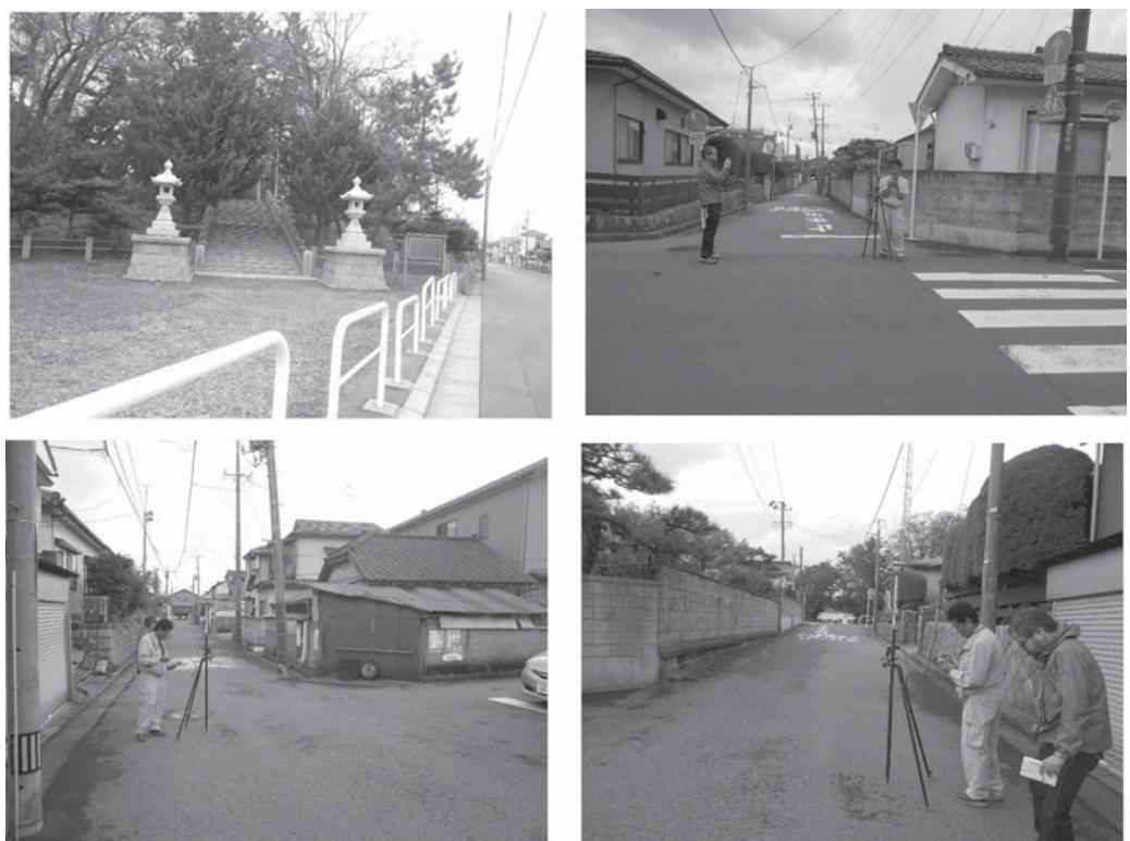
写真 6 山ノ下標高点。（左上）山ノ下神明宮、（右上）同宮前道路面測定点（点B）、（左下）神明宮から約 200 m 南下下 T 字路測定点（点C）、（左下）点 C を南から北向きにとった写真。先の道路はかなりの登り勾配。突き当たりに神社がある。この C 点がほぼ浸水限界線と考えられる
