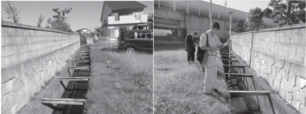
写真18 図23のQ点での暗渠内水面水位の測定
