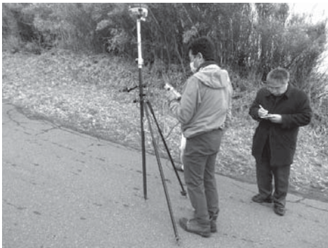
写真 43 泊・参詣道途中、標高の高い家屋の敷地と同じ標高の点 (P 点)
