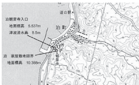
図 34 江差町泊の測定点
