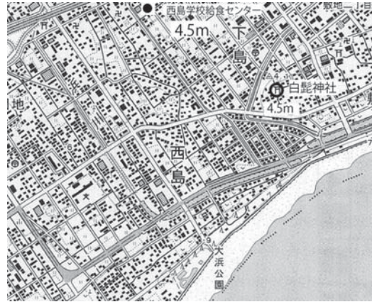
図 34 静岡市駿河区西島の西島学校給食センターの測量点と、羽鳥（1976）による白髭神社での浸水高
