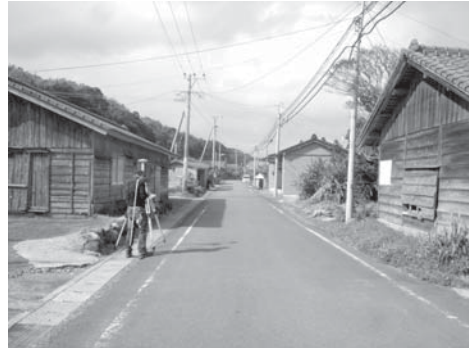
写真2 庄司浦旧街道から港へ下る道の途中の点での地盤測量 写真奥の反射鏡のある位置が旧街道。図2の5.9mの位置の写真である。
