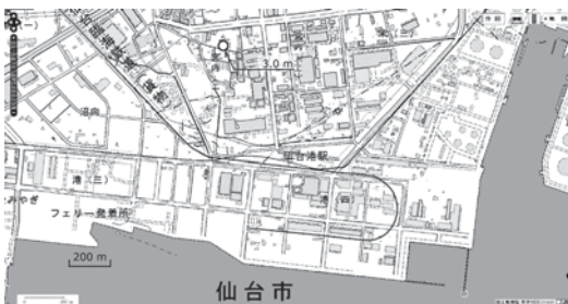
図-10 宮城県多賀城市における津波痕跡位置
