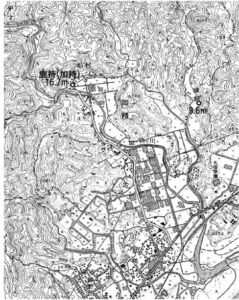
図 22 黒潮町加持と猿飼の津波浸水高さ測定点
