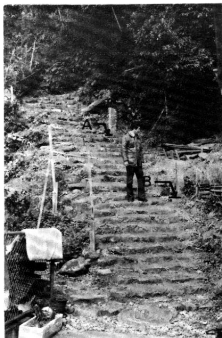
写真-8. 観音堂石段（浅川） 安政の津波来襲点 25段（A） 南海地震津波来襲点 13段（B）
