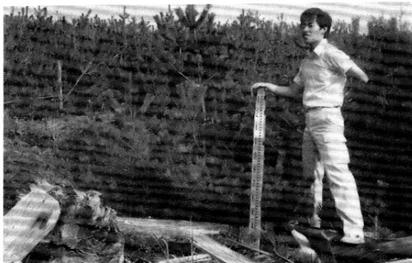
写真-10 峰浜村沼田の砂丘上に打上げられた漂流物。ここでの痕跡高は T.P. 12.19mであった。
