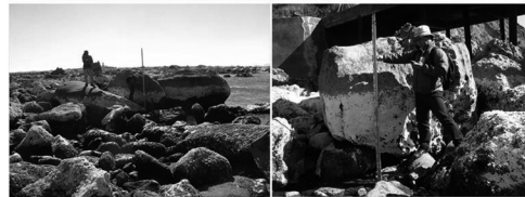
図-11 Lebu の岩礁における白化現象 (平均の白化上端位: 左図 2.36 m, 右図 2.35 m)
