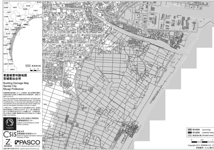
図 4 航空写真の目視判読により得られた建物被害地図
