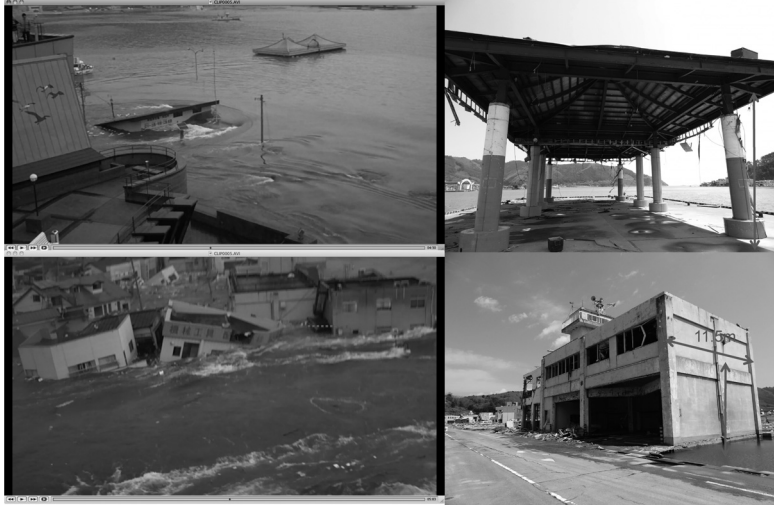
図2 津波来襲時のビデオ映像の解析による現地の水位の計測例
