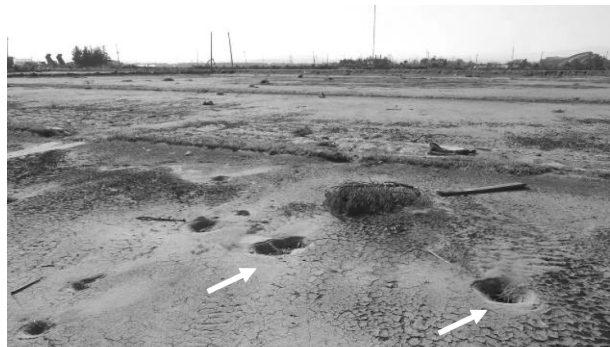
図-5 測線 A の水田地帯で観察される噴砂痕.
