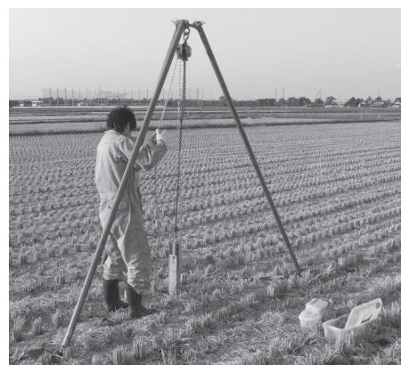
写真 2-1：ジオスライサーによる水田内での津波堆積物の掘削。写真はコア引き抜き作業の様子。
