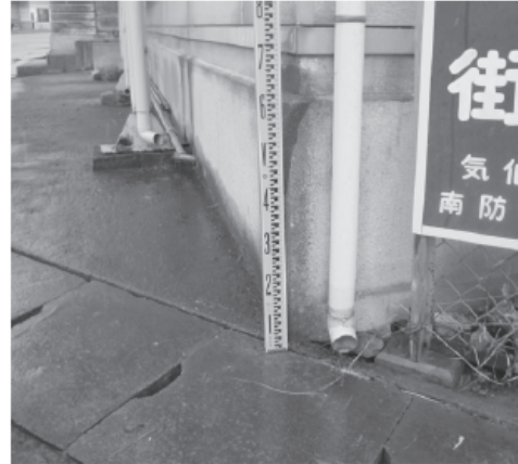
緯度：38°53'38.69″，経度：141°34'52.4″ 緯度：38°53'40.34″，経度：141°34'54.9″ 写真8 中央公民館付近での浸水高さの測定
