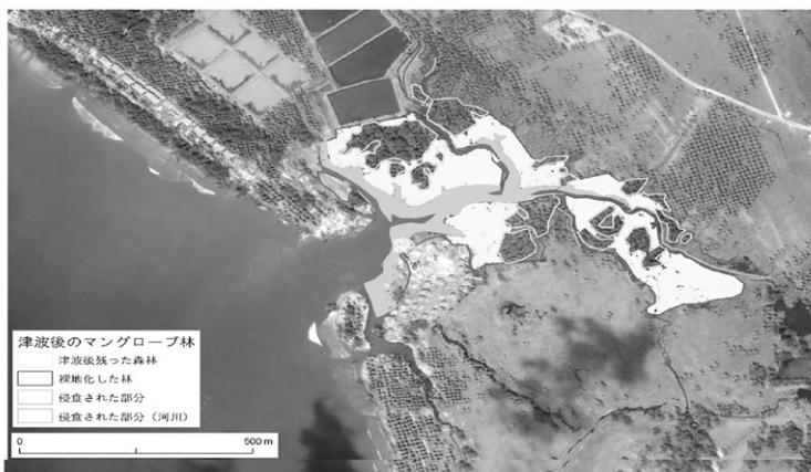
図 16 カオラック地区津波による土地破壊の状況
