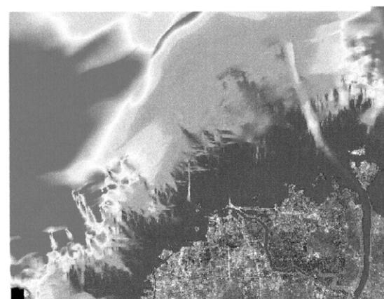
図25 バンダアチェと周辺における2004年インド洋大津波の水流圧力(N/m)
