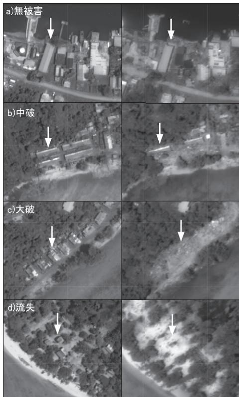
図-6 津波による建物被害の目視判読例
