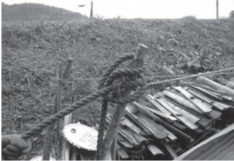
図 10. ビット①の係留ロープの巻き方(強く)
