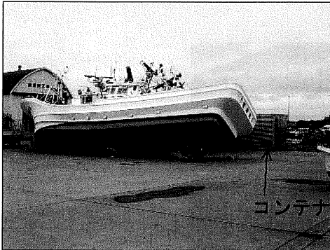
図 130-1 大津港ドックの津波で台座から外れて傾いた漁船と痕跡が残るコンテナ
