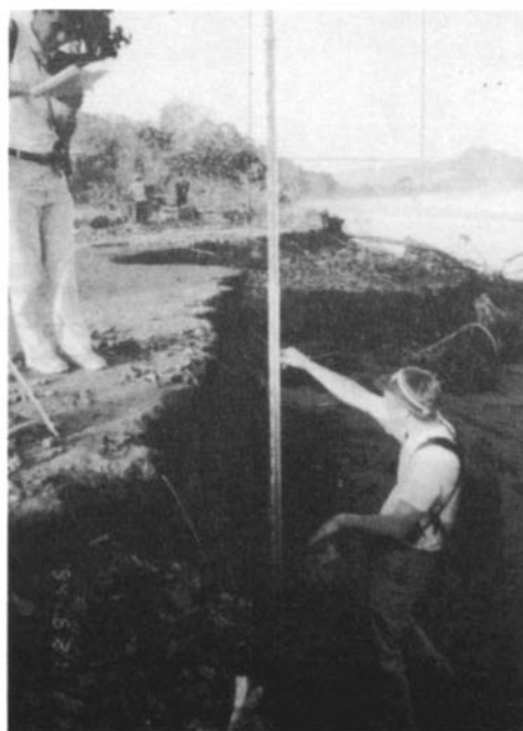
写真-4 Rajekwesiでの最大2mにも及ぶ段差
