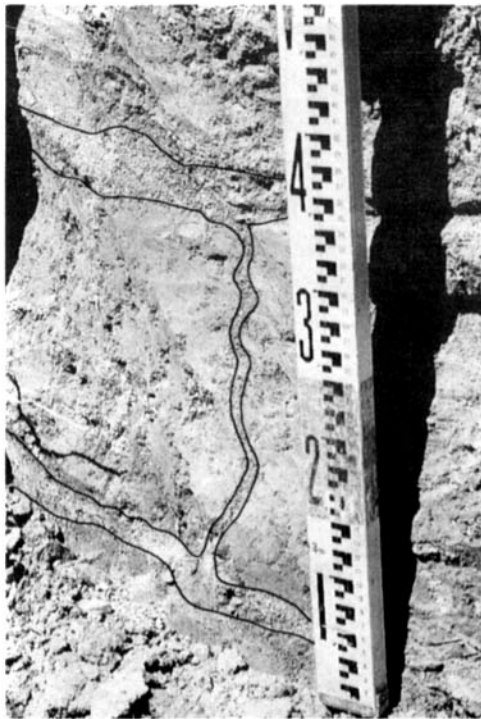
写真-6 Dalamanで発見された砂層と液状化後
