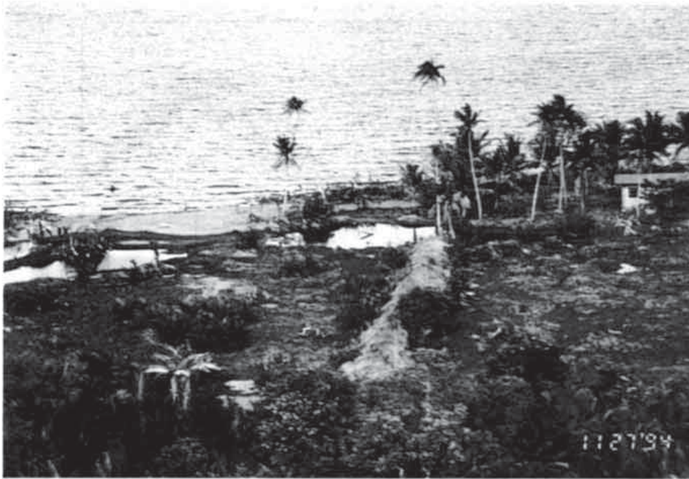
写真-4 バコで見られた砂の堆積による河口閉塞 (航空写真)
