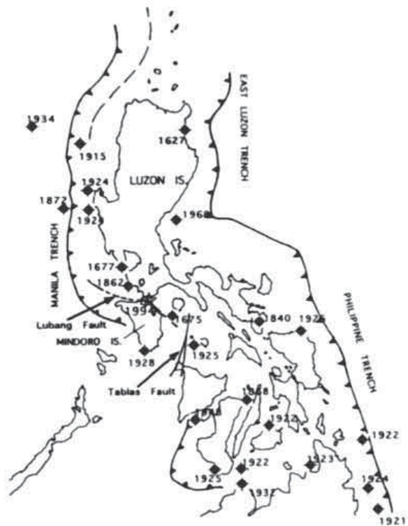
図-1 フィリピン中北部のテクトニクスと過去の津波を伴った地震の震源位置。図中には1994ミンドロ地震を星印で示している。フィリピンは東西にプレートの沈み込みがあり、それに沿って多くの津波が発生している。
