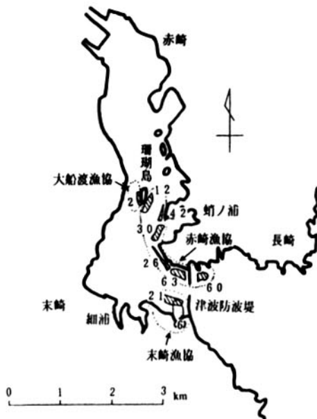
図-17 大船渡湾での水産施設被害 斜線は津波，点は台風による。
