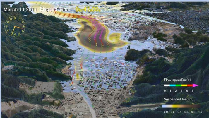
左図: 津波第一波の押し波来襲時の様子。気仙沼湾狭窄部の侵食により、津波の侵入が容易になる。勢いを増した津波により、船舶が市街地へ流され、建物破壊や瓦礫化の拡大に影響すると考えられる。
